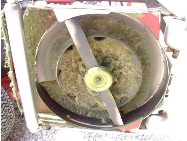
Sichelmäher mit unsauberen Blechen, die die Luftführung beeinträchtigen
